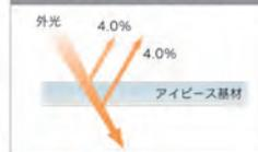
微細な凹凸により屈折率を連続的に変化させることで、ほぼすべての光の反射を防ぐことができます。
